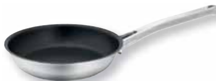
NOSER Bratpfanne «Phytherm» NOSER Poêle a frire «Phytherm» INDUKTIONSGEEIGNET. Controlinduc Material verhindert ein Überhitzen auf über 250° C auf Induktionsherden. Bei 250° C verliert die Pfanne den Magnetismus, sodass sie auf Induktionsherden nicht weiter erhitzt wird. INDUCTION. Le matériau «Controlinduc» empêche la surchauffe dès 250° C sur les cuisinières à induction. A 250° C, la poêle perd son magnétisme, ce qui empêche la plaque de surchauffer.
