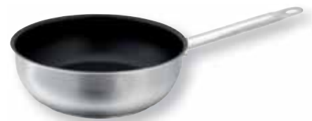
NOSER Bratpfanne hoch «Phytherm» NOSER Poêle a frire haut «Phytherm» INDUKTIONSGEEIGNET. Controlinduc Material verhindert ein Überhitzen auf über 250° C auf Induktionsherden. Bei 250° C verliert die Pfanne den Magnetismus, sodass sie auf Induktionsherden nicht weiter erhitzt wird. INDUCTION. Le matériau «Controlinduc» empêche la surchauffe dès 250° C sur les cuisinières à induction. A 250° C, la poêle perd son magnétisme, ce qui empêche la plaque de surchauffer.
